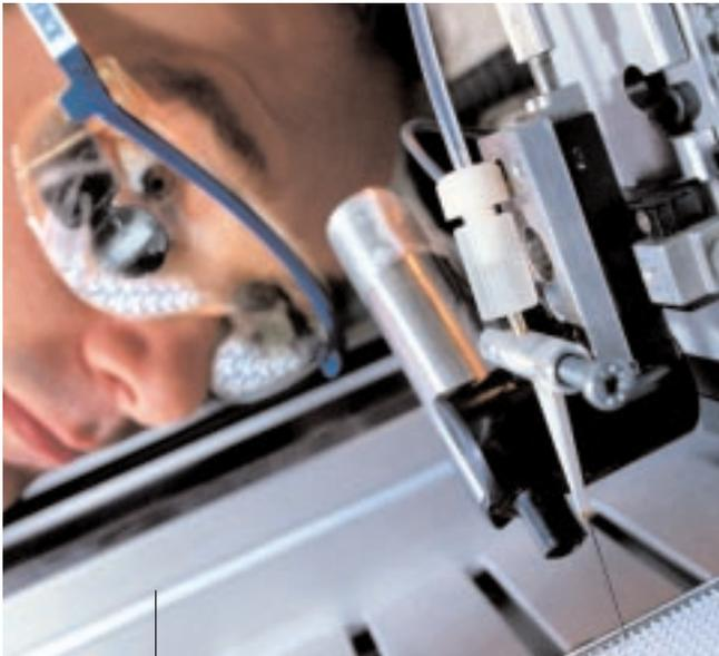
Alexander Groß, Doktorand aus Jena in der Präklinischen Forschung bei Merck, fokussiert seinen Blick auf eine Videokamera des NST® (Nano-volume Synthesis & Testing) -Systems. Die innovative Technologie – einige Aspekte konnten zum Patent angemeldet werden – erlaubt die automatische Verteilung von kleinen Partikeln in Mikrotiterplatten. Diese werden zur Synthese von Substanzbibliotheken für das Ultra-Hochdurchsatzscreening bei der pharmazeutischen Wirkstoffsuche eingesetzt.
